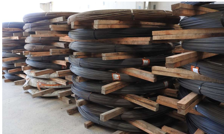
Bobinas de acero para pretensado – banco largo
